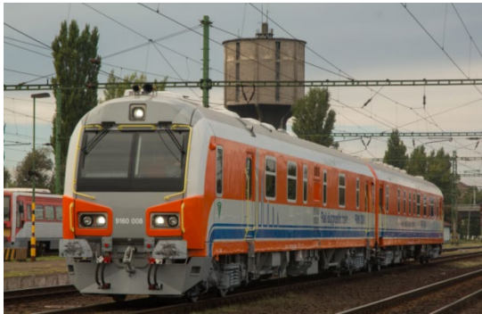
FMK-008: ultrahang, örvényáram, keresztmetszeti és hosszanti sínprofil
